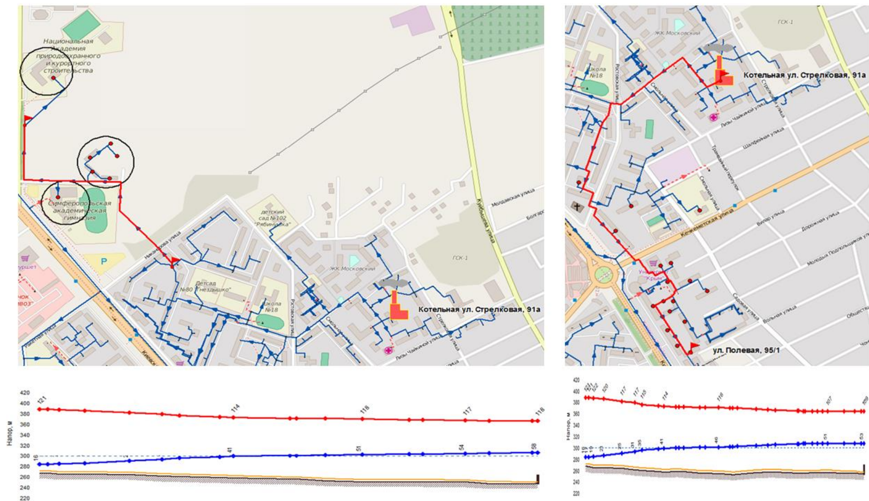
Рисунок 7. Пьезометрические графики в режиме резервирования потребителей Симферопольской ТЭЦ от котельной по ул. Стрелковая, 91а
